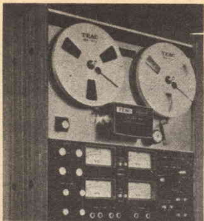
Il registratore a nastro Teac Mod. 2340 può registrare e riprodurre quattro canali distinti.
